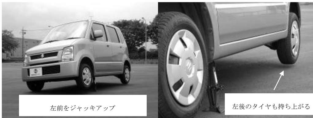
写真4 ジャッキが最伸長になるまでジャッキアップし、車体が不安定になる例
