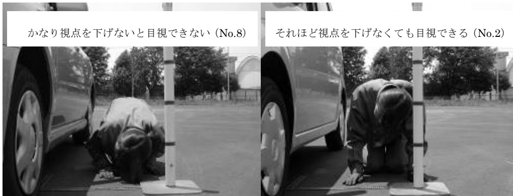
写真2 サイドスカートの影響でジャッキアップポイントが目視しにくい例
